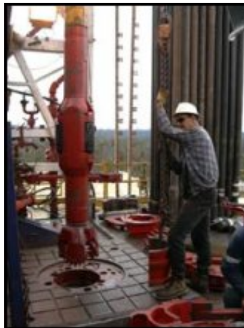
Operario Petrolero ruso maniobrando con una punta de perforación en Kola
